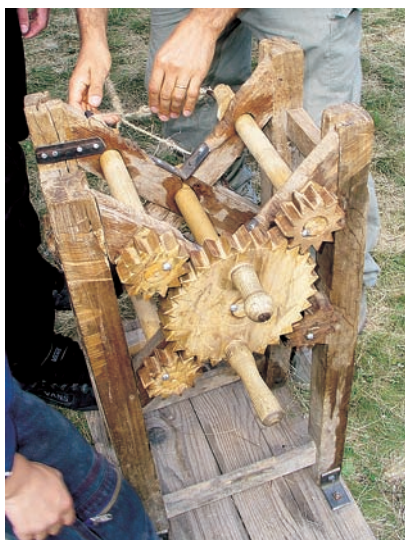
Figure 7 : Décrochage des torons après l'opération de câblage.
