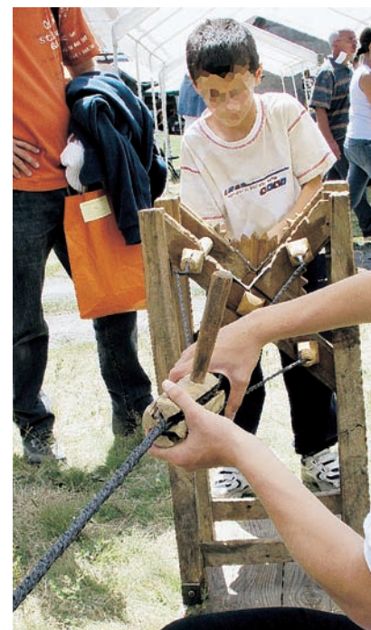
Figure 10 : Une étape délicate : le maniement de la « masséta » et le contrôle de la tension dans les câbles.
