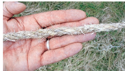
Figure 11 : Le cordage en chanvre de 7 à 8 mm entièrement fait main.
